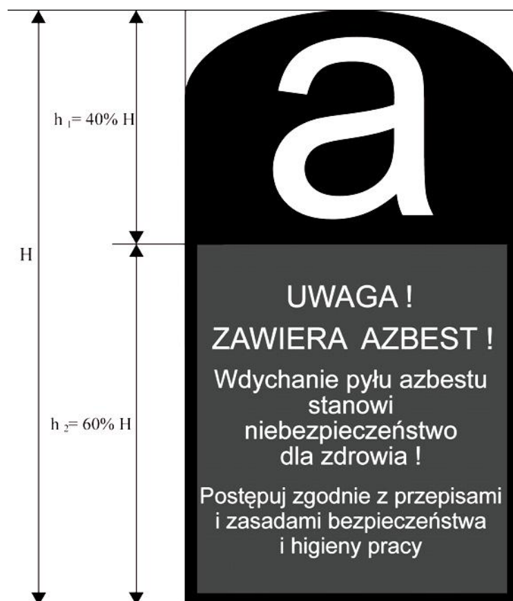
Rysunek 3. Wzór prawidłowego oznakowania wyrobów, odpadów i opakowań zawierających azbest, a także miejsc ich występowania.
